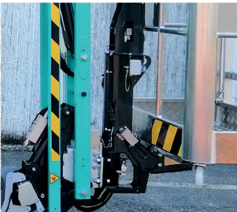
Compacité de l'ensemble flèche recevant le capteur de pesage et le système de montage rapide du panier.
