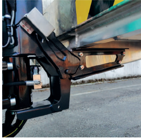
Système de fixation du panier conçu pour faciliter le montage.
