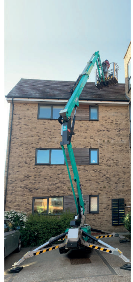
Le bras articulé avec JIB et la rotation du panier de \pm 62^\circ , ainsi que le pivotement de la tourelle de 360^\circ (non continu), permettent un positionnement optimal de la machine dans toutes les situations de travail.
