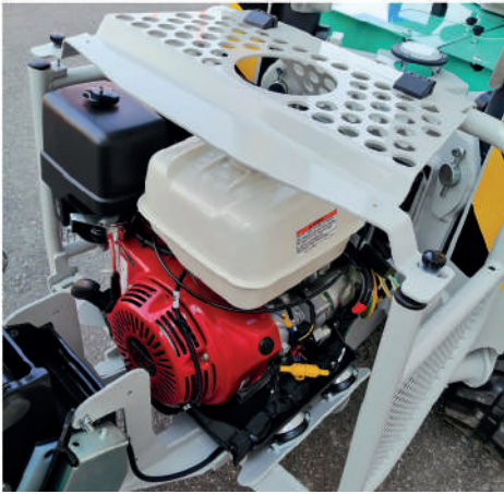
Moteur protégé par une structure robuste qui évite les dommages en cas de chute de matériel.
