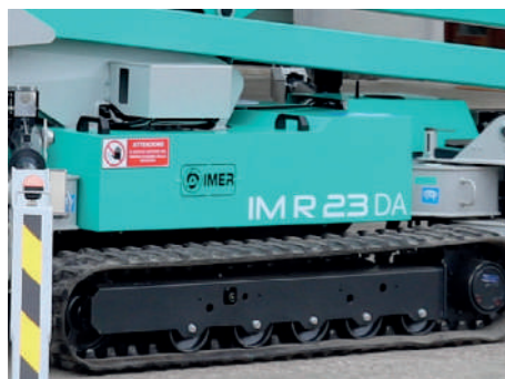
Largeur des chenilles réglable hydrauliquement : plus de stabilité et de traction pour se déplacer sur le chantier ou sur un terrain accidenté.
