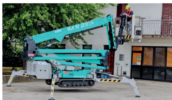
Châssis entièrement fermé pour assurer la protection des composants hydrauliques et électroniques.
