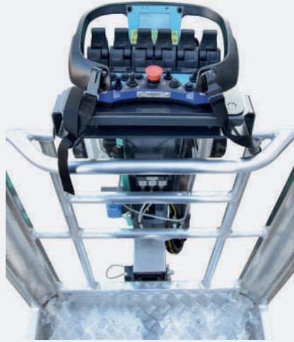
Panneau de commande intuitif avec support externe au panier. Plus d'espace disponible dans le panier.
