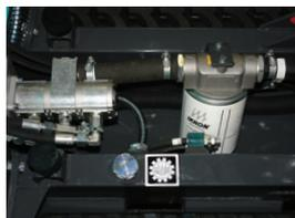
Réservoir d'huile hydraulique incorporé au châssis
