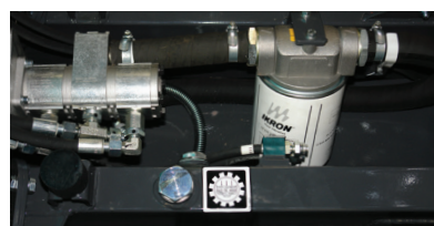
Réservoir d'huile hydraulique incorporé au châssis
