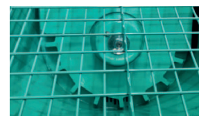
Nouvelle conception de roue à cellules plus grandes pour améliorer la collecte de matériaux fibreux.
