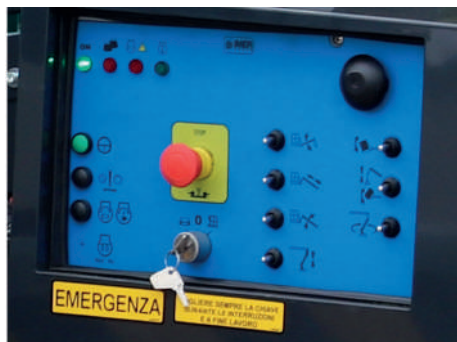
Panneau de contrôle poste bas.
