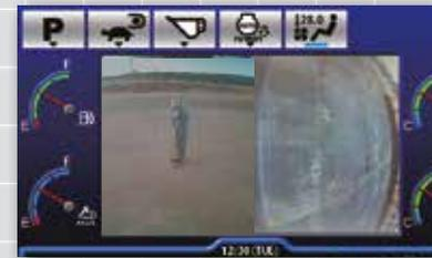
L'image de la caméra de vision arrière s'affiche directement sur le moniteur. Deux images de caméras différentes peuvent être affichées simultanément sur l'écran.
