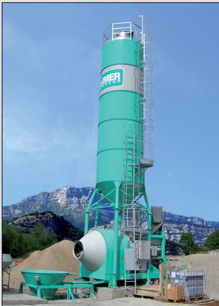
Centrale de chantier hydraulique à tambour horizontal. Les centrales BTK sont compactes, flexibles et adaptées aux chantiers de toutes dimensions. Elles assurent un fonctionnement en continu et entièrement autonome.
