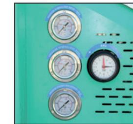
> Manomètres de pression hydraulique
