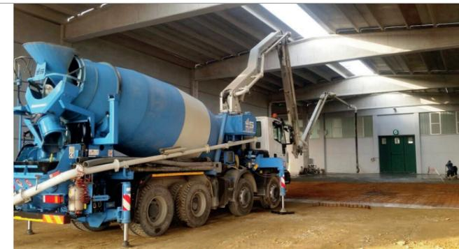
Les stabilisateurs sont contrôlés hydrauliquement par deux distributeurs placés sur les deux côtés de la machine pour permettre la mise en fonction en toute sécurité. **Les cylindres de lavage sont dotés de valves de blocage hydrauliques qui garantissent la stabilité de positionnement.**
