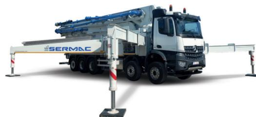
La législation européenne **UNI EN 12001:2012** prévoit le contrôle de la stabilité de la machine avec l'ouverture totale ou partielle de la stabilisation.
