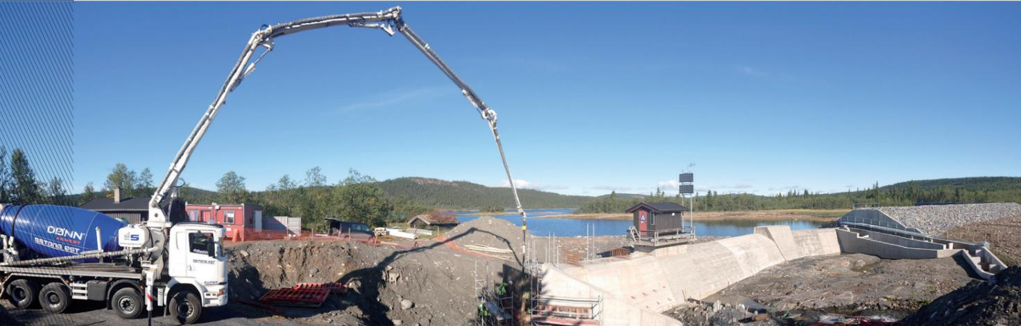
Conçues et fabriquées par **SERMAC**, les modèles **TWINSTAR** ont la flèche de distribution à section boîtée et soudée avec un repliement à "Z" qui assure un poids inférieur et une plus grande sécurité de la flèche.
