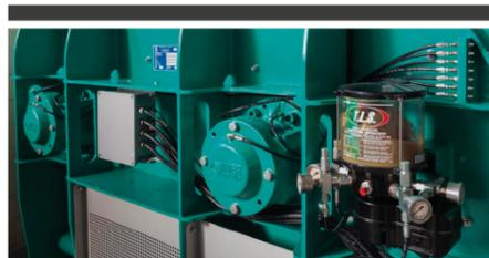
Système de graissage automatique muni de 4 pompes programmables et indépendantes
