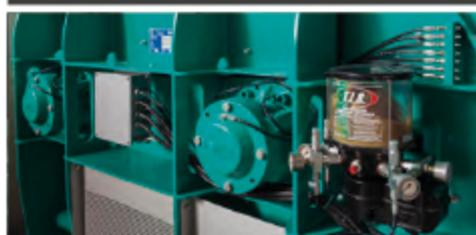
Système de graissage automatique muni de 4 pompes programmables et indépendantes
