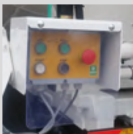
> Boîtier de commande avec START / STOP et arrêt d'urgence
