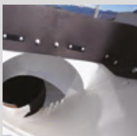
> Blindage anti-usure sur la trémie
