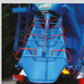
> Goulotte télescopique LT 555 déploiement à 5,5 m
