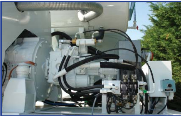
Réducteur, pompe, moteur et groupe hydrauliques
