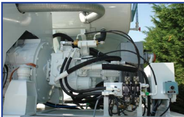
Réducteur, pompe, moteur et groupe hydrauliques
