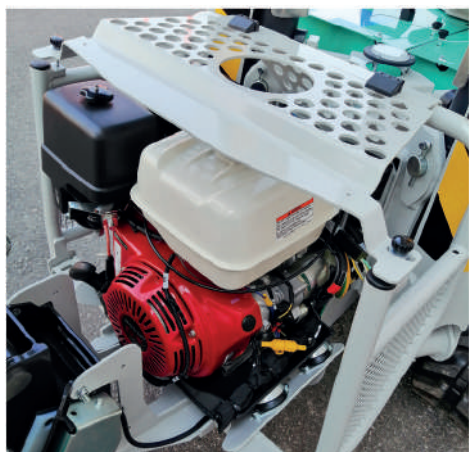
Moteur protégé par une structure robuste qui évite les dommages en cas de chute de matériel.
