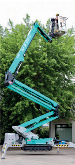
Flèche à double articulation avec section télescopique et flèche hydraulique pour assurer une excellente manœuvrabilité et un bon positionnement.
