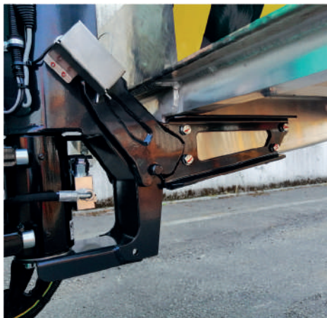
Système de fixation du panier conçu pour faciliter le montage.
