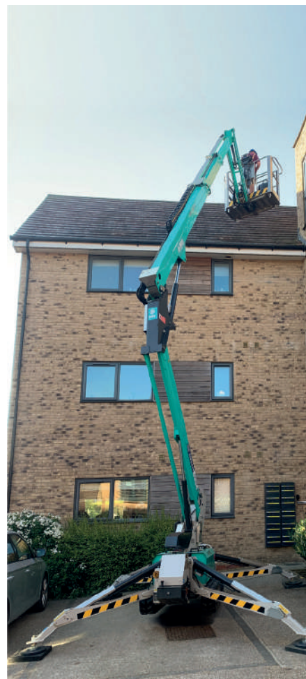
Le bras articulé avec JIB et la rotation du panier de \pm 62^\circ , ainsi que le pivotement de la tourelle de 360^\circ (non continu), permettent un positionnement optimal de la machine dans toutes les situations de travail.
