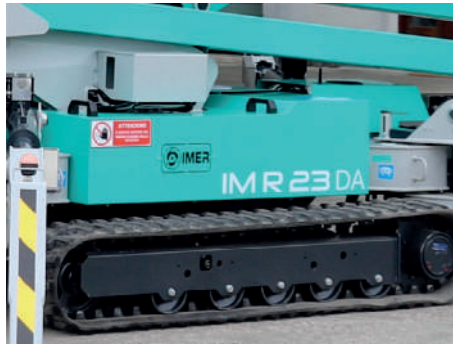
Largeur des chenilles réglable hydrauliquement : plus de stabilité et de traction pour se déplacer sur le chantier ou sur un terrain accidenté.
