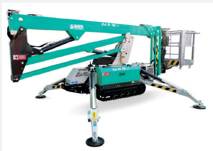
Taille compacte, avec un encombrement limité des stabilisateurs. La stabilisation automatique standard permet un positionnement optimal et rapide de la machine.
