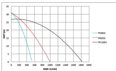
Ces séries TP sont adaptées aux transferts d'eaux claires et moyennement chargées en acceptant des particules allant jusqu'à 7.5 mm. Le groupe motopompe TP36 EX est équipé de moteur professionnel EX WORMS haute performance. Des matériaux de hautes performances tels que la garniture mécanique en carbone céramique et le corps de pompe en fonte d'aluminium moulé injectée sous pression offrent une excellente fiabilité et longévité.
