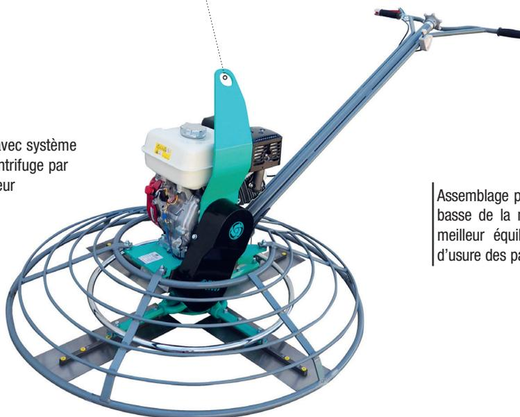
Double système de sécurité avec système homme mort électrique et centrifuge par coupure de l'embrayage moteur
