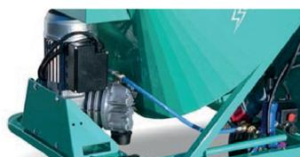
Compresseur à membrane fixé sur la machine.
