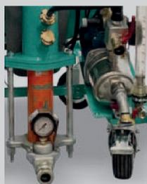
Bride de roulement de matière en fonte avec manomètre. Raccordement direct pour tuyau DN35 F. Il permet de rallonger les tuyaux jusqu'à 50 m minimisant ainsi l'usure de l'ensemble stator-vis.
