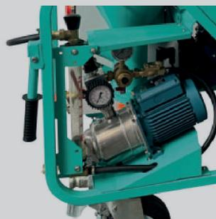
Disposition des composants destinée à améliorer le drainage de l'eau en hiver. Pompe électrique auto-amorçante de dimensions généreuses, 4,5 bars de pression, avec chapeau en acier inoxydable et roue en laiton.
