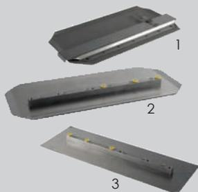
1. Ebauche (pales d'ébauche et de plateau) : Ces lames permettent de dégrossir avant le passage des pales de finition. Elles se fixent à l'aide d'un clip sur la lame existante installée (en général une lame de finition). Cela permet à la machine de flotter sur le béton mouillé pour commencer le talochage au plus vite.
