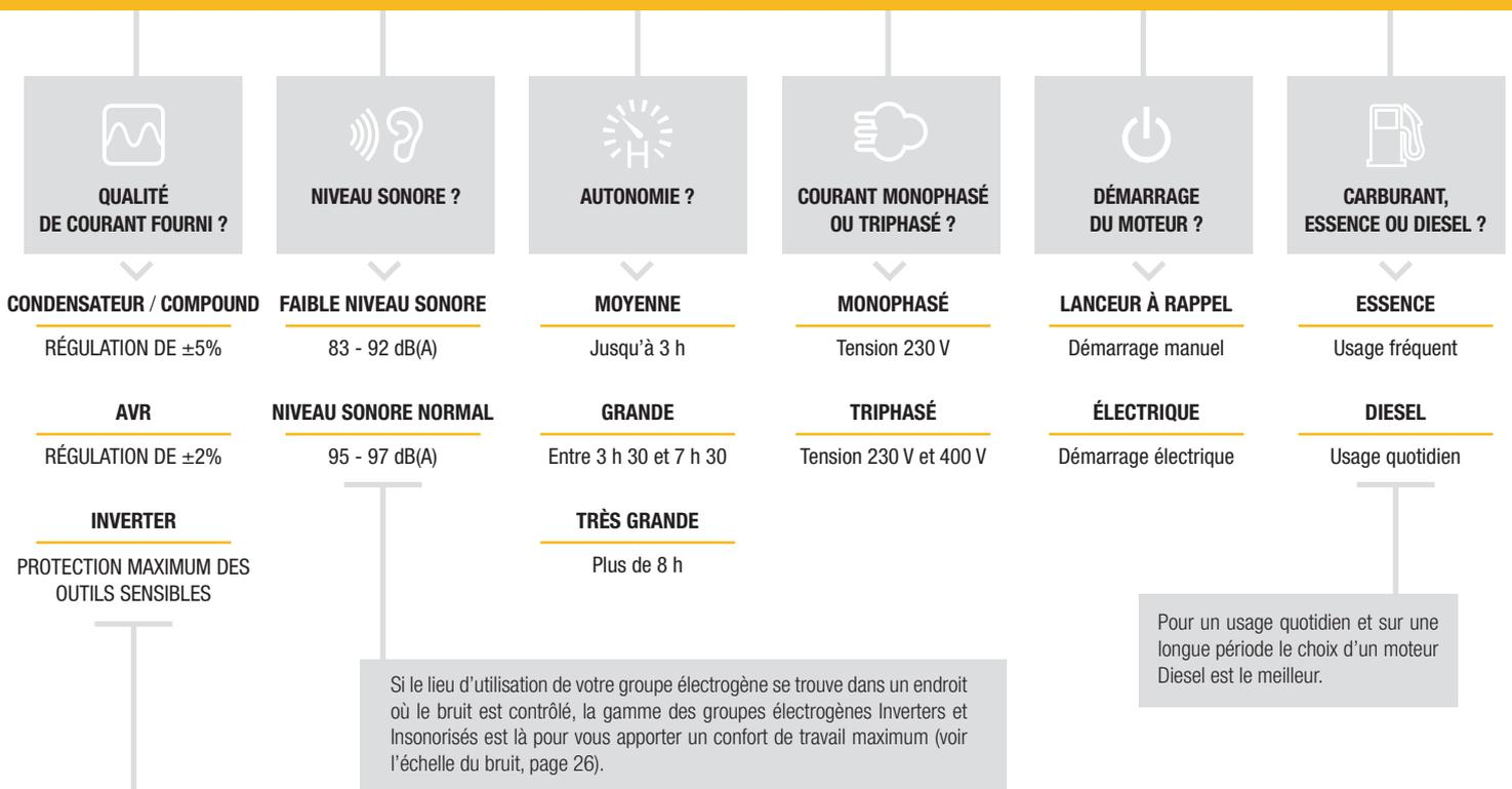
Les outils électriques les plus simples ne requièrent pas de qualité de courant particulière. Par contre les équipements électriques à régulation électronique exigent un maintien précis de la tension comme de la fréquence du courant fourni. Nous vous proposons trois types de régulation couvrant tous vos besoins :
