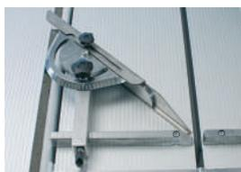
Grande longueur de coupe : 760 mm maxi, permet de couper en diagonale un carreau de 500 mm de côté
