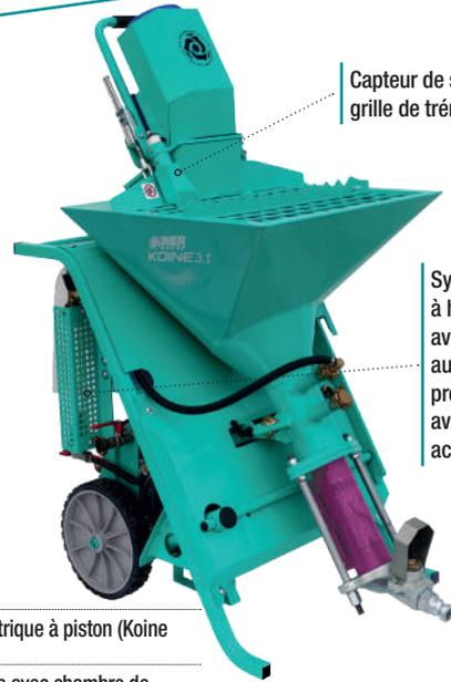
Capteur de sécurité de grille de trémie
