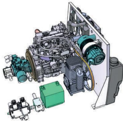
Moteur diesel refroidi par liquide.
