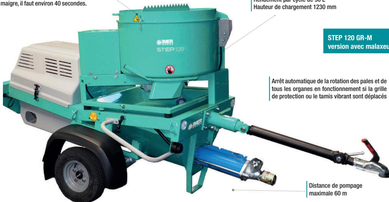
Arrêt automatique de la rotation des pales et de tous les organes en fonctionnement si la grille de protection ou le tamis vibrant sont déplacés
