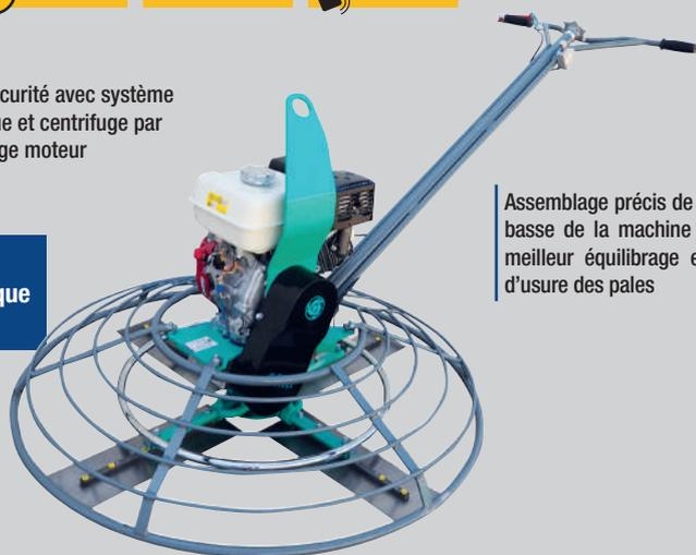
Double système de sécurité avec système homme mort électrique et centrifuge par coupure de l'embrayage moteur
