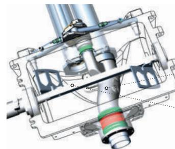
Valve de refoulement en "S" avec système d'étanchéité. Rattrapage automatique de l'usure par anneau auto-ajustable sur le tube en S.
