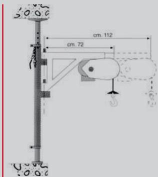
Avec élévateur à potence télescopique
