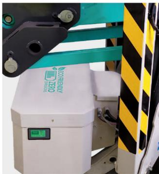
Compartiment batteries lithium protégé et facilement accessible pour la gestion du cycle de charge. Ecran LCD pour vérifier l'état de charge et le temps restant de la batterie.
