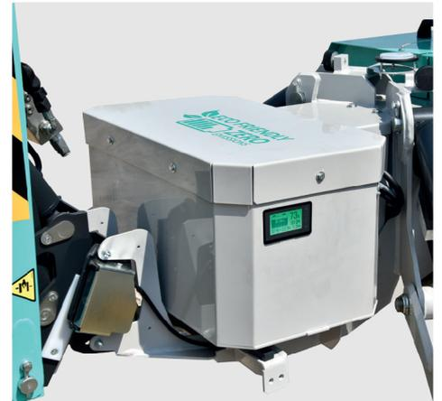
Compartiment pour les piles au lithium : protégé et facilement accessible pour la gestion du cycle de charge. Affichage LCD de l'état de charge et du temps restant de la batterie (IMR 19 SA EVO Lithium)
