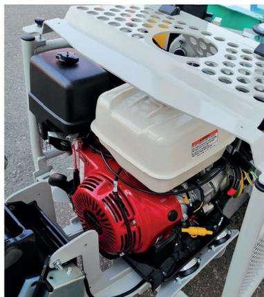
Moteur protégé par une structure robuste qui évite les dommages en cas de chute de matériel.
