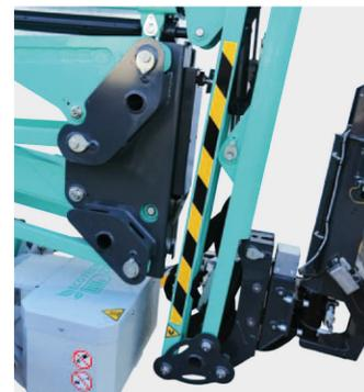
Compacité de l'ensemble flèche recevant le capteur de pesage et le système de montage rapide du panier.
