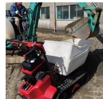
Le mini-transporteur SC30 est tout particulièrement apprécié pour les petits travaux de transports divers. Sa petite taille lui permet de se faufiler aisément dans les allées étroites et de travailler dans des endroits exigus. Son moteur électrique sur batteries supprime les nuisances sonores, les gaz d'échappement et facilite l'entretien.
