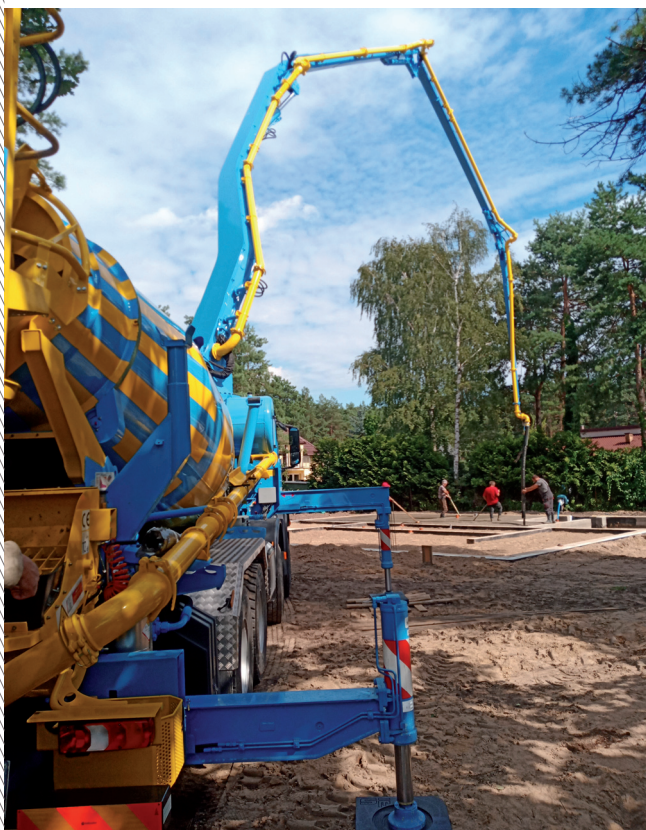
Exemple de modèle de malaxeur pompe 4Z33-5"
