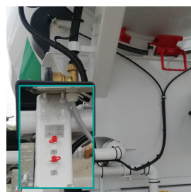
> Graissage déporté des galets sur poste de commande
