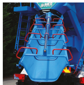
> Goulotte télescopique LT 555 déploiement à 5,5 m
