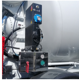
> Réservoir d'huile avec sonde de température et vanne 3 voies en inox
