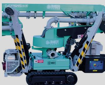
Moteur principal Honda GX390. Démarrage électrique à partir du tableau de commande ou de la radiocommande.
