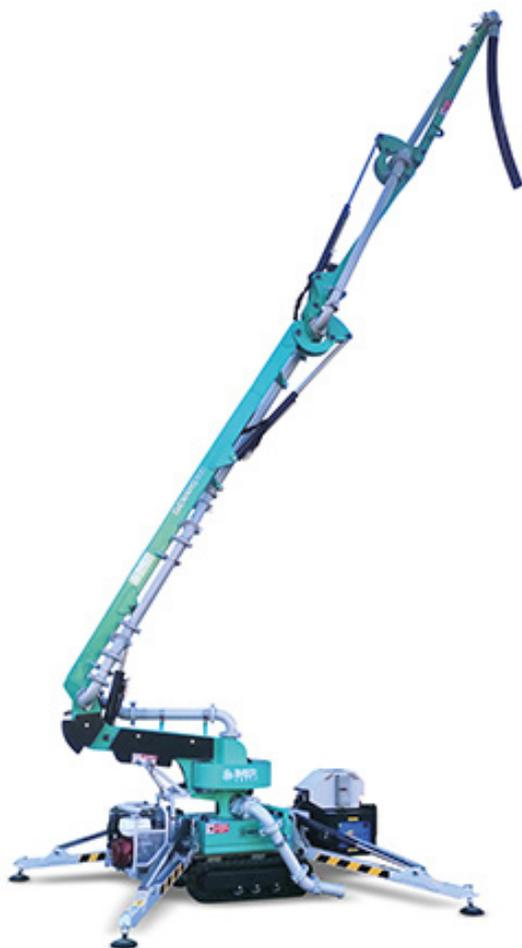
Convient au transport de mortier/béton pompé d'une granulométrie maximale de 25 mm (1") :
