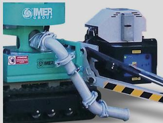
Ø 100 (4") collecteur de raccordement du tuyau à matériaux, facilement amovible pour la manipulation de la machine.
