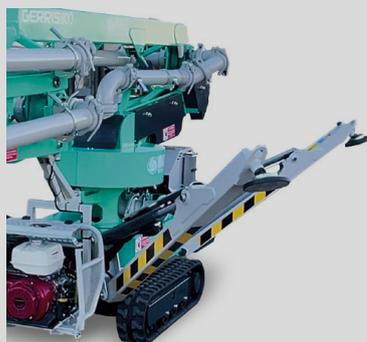
Machine auto-propulsée sur voies variables, pour une mobilité aisée même sur les terrains les plus accidentés.
