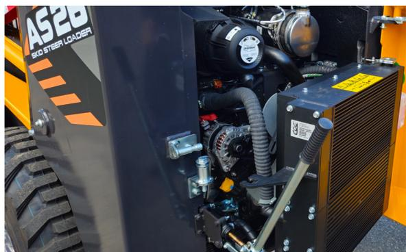
Radiateur air-eau-huile avec bac d'expansion d'eau monté sur charnières ouvrables
