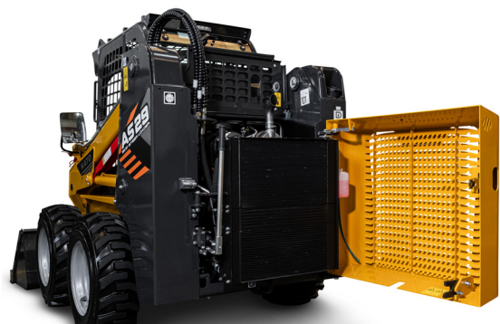
Radiateur air-eau-huile avec bac d'expansion d'eau monté sur charnières ouvrables
