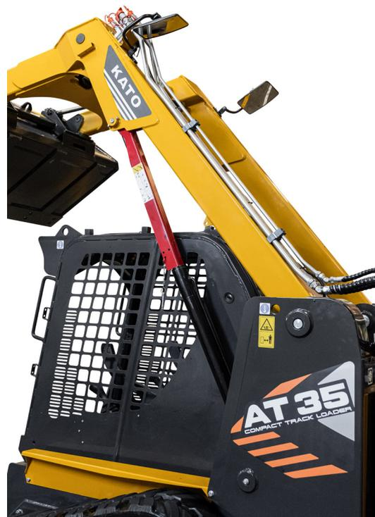
Sécurité : Mise au ralenti automatique du moteur lorsque les barres de sécurité sont relevées
