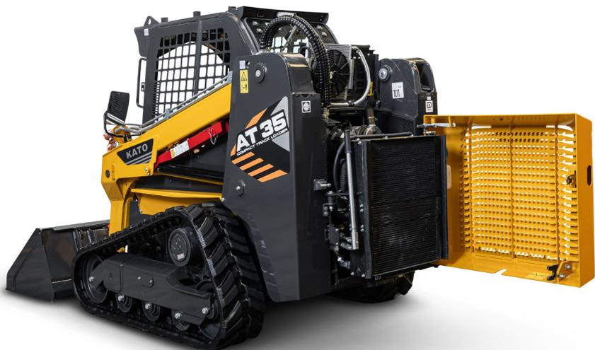
Radiateur air-eau-huile avec bac d'expansion d'eau monté sur charnières ouvrables
