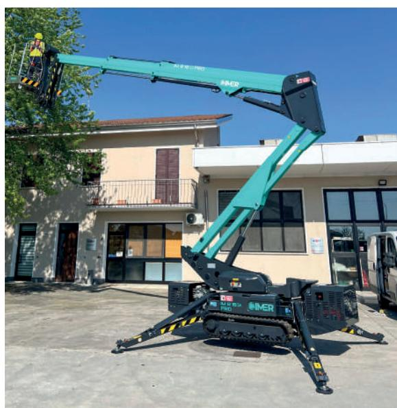
Flèches à articulation simple avec portée latérale maximale de 9,6 m / 90 kg (IM R 18 SA) et 11 m / 90 kg (IM R 18 SA PRO)
