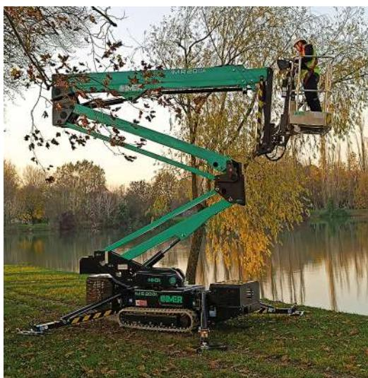
Flèches à double articulation avec portée latérale maximale de 10 m / 230 kg
