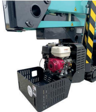
Capot moteur robuste pour une meilleure protection contre les chocs, avec un système d'ouverture facile.
