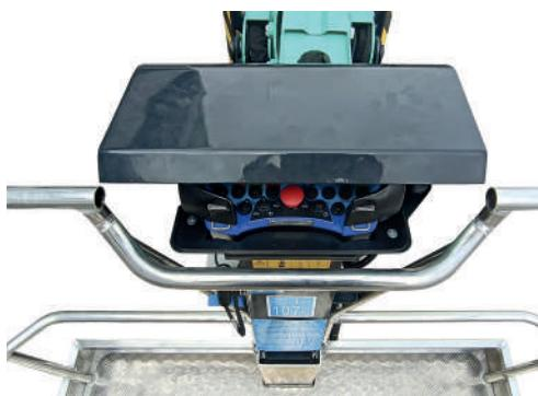
Capot de protection de la radiocommande sur le pupitre de commande du panier pour une protection complète de la télécommande
