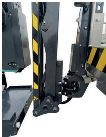
Flèches compactes avec cellule de charge et système de rotation du panier
