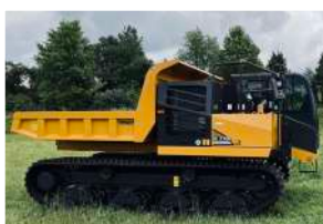
TRANSPORTEURS A CHENILLES Charge utile de 1 à 10 tonnes
